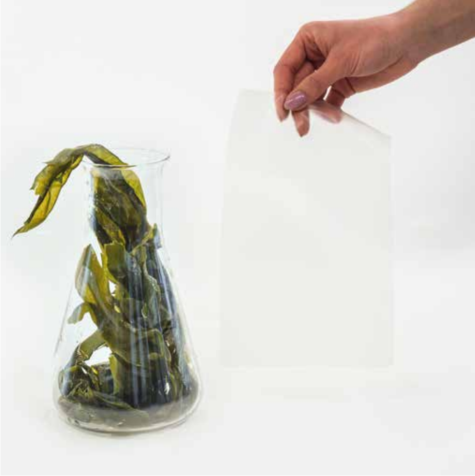
Aus dem schnell nachwachsenden und für die Umwelt unproblematischen Rohstoff Algen (links) lässt sich eine Folie herstellen, die die Eigenschaften einer Plastikfolie besitzt, jedoch innert kürzester Zeit kompostierbar ist.
